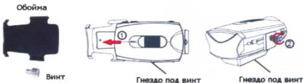
Пластиковая обойма, идущая в комплекте, служит для установки устройства на различные держатели. Необходимо вставить устройство в обойму и зафиксировать его винтом.
